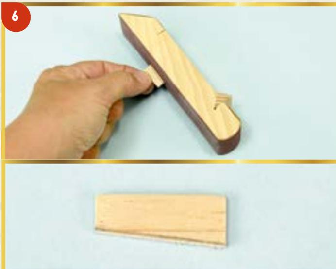
**6** С помощью наждачной бумаги сточите склеенные планки по проведенной линии. В итоге вы получите две трапециевидные детали.
